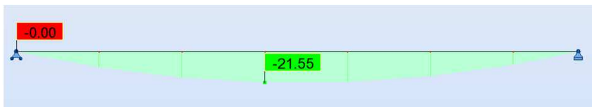
Valeur de la contrainte maximale à mi-travée (Mpa) selon la combinaison ELU
